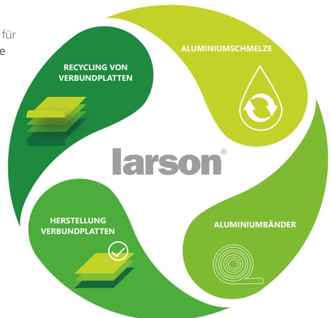
Die Wiederverwertung von **larson®** Verbundplatten am Ende deren Lebensdauer ist unproblematisch. Die Beschichtung wird einfach entfernt und der Rohstoff der Schmelze zugeführt, wo er erneut in die Kreislaufwirtschaft eintritt.
