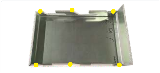
3. Plegar a 90° los cantos laterales y las partes triangulares de la parte superior e inferior de la bandeja para su conformado.
